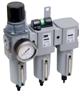
3M AirCare -ilmansuodatusyksikkö ACU03 Seinäasennus Tulo 1/2" BSP tai 3/8" BSP. Lähtö 3/8" BSP.
